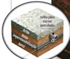
**3** Para drenar o percolato (líquido que sai do lixo misturado à água da chuva) a cada 20 metros são instaladas calhas de concreto, que levam a mistura nojenta até a lagoa de acumulação
